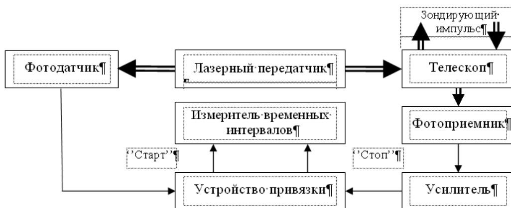
Рисунок 1 – Упрощенная структурная схема прохождения сигнала в лазерном дальнометре ЛЛС
